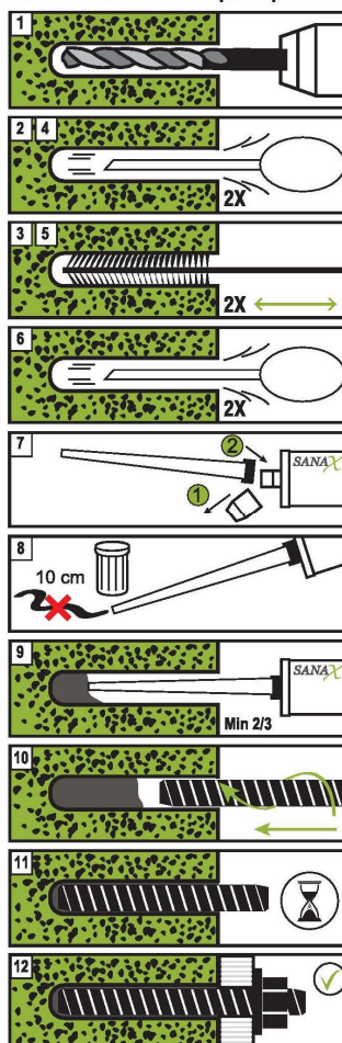
ResiFix 2EX Instalační postup
