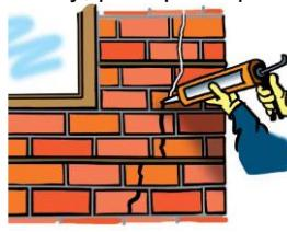
9) Trhlinu vyplním pevnostní maltou nebo maltou ResiBond MC.
