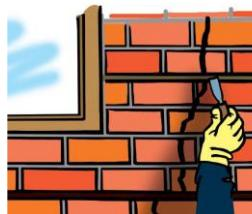
7) Spárovací špachtí zatlačíme tmel do drážky a tu na závěr zahladíme; pokud je drážka vyplňena do roviny stávající zděné konstrukce, nejsou nutné žádné další úpravy, případně je možno provést jakoukoli povrchovou úpravu (omítka), která je vhodná pro okolní materiál.
