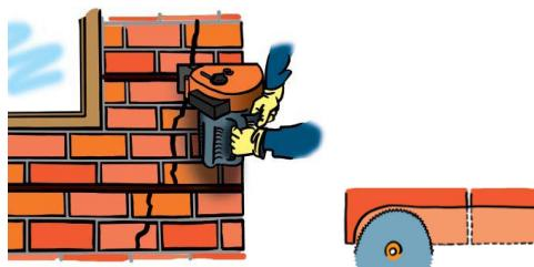
1) Drážkovací frézkou na zdivo se vyfrézuje drážka s dvěma vhodně zvolenými kotouči na řezání zdiva, s nastavitelnou hloubkou řezu. Minimální hloubka řezu pro 1 výztuž je 35mm pod lícem zdiva. Šířka drážky je 10 mm.
