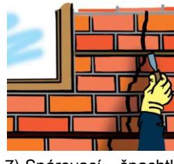
7) Spárovací špachtlí zatlačíme tmel do drážky a tu na závěr zahladíme; pokud je drážka vyplňena do roviny stávající zděné konstrukce, nejsou nutné žádné další úpravy, případně je možno provést jakoukoli povrchovou úpravu (omítku), která je vhodná pro okolní materiál.
