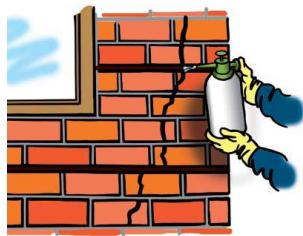
2) Drážka se vyfouká, zbaví hrubších nečistot a prachových částic, před vlepením výztuže se navlhčí, nejlépe vypláchně čistou vodou. Při vysokých teplotách použít ResiPrimer WB.
