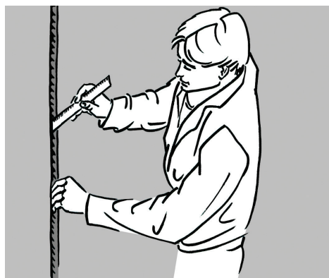
Obr. 2 Označení místa, kde se budou vrtat otvory. Otvory jsou rozmístěny podél trhliny na střídavých stranách v intervalu 10 cm až 15 cm.
