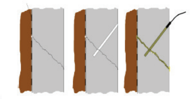
Obr. 3 Směr a způsob vrtání
